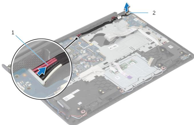
1 Kabel vrat za napajalnik
