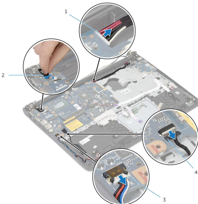
1 Kabel vrat za napajalnik
